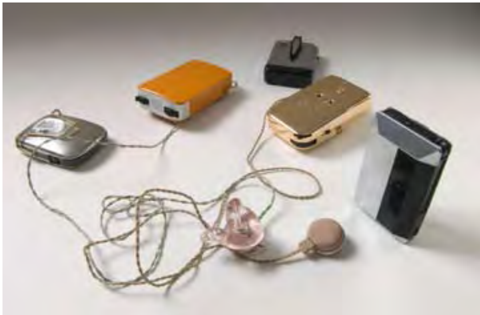
ca. 1960. Kasttoestel met kristalmicrofoon en ontvanger, versterker en accu
