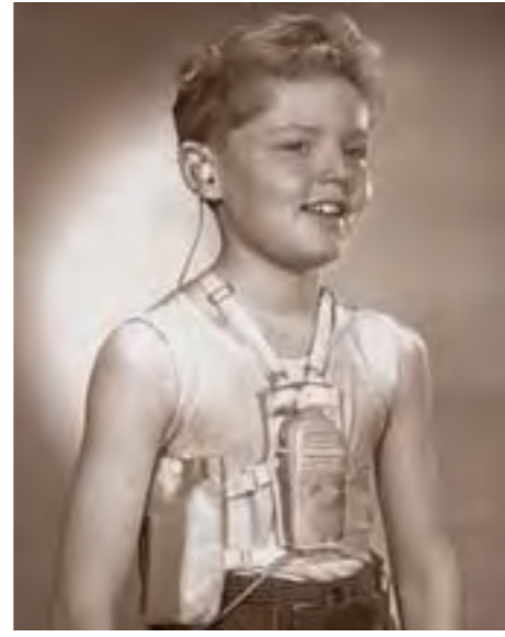
ca. 1940. Kind met buizenhoortoestel op de borst. De batterij draagt hij onder de arm
